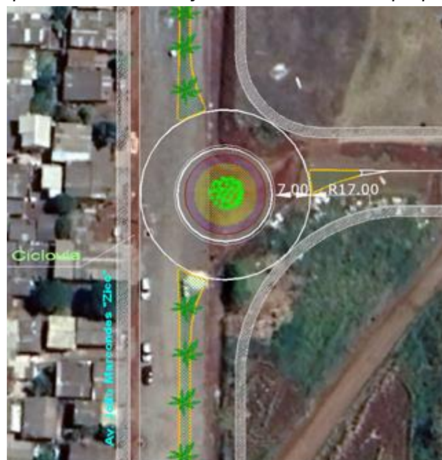
Figura 4.1.7 – Desenho funcional da rotatória proposta
